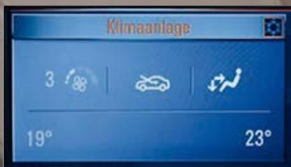
**Mostrador do ar condicionado de comando electrónico (ECC).** O Opel Insignia permite conduzir sempre com o melhor tempo possível. O mostrador, baseado em menus, é de fácil utilização e permite ao condutor e ao passageiro da frente definir individualmente a temperatura preferida, seguindo simplesmente os ícones apresentados.
