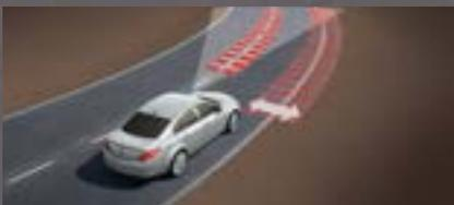
A câmara detecta as linhas delimitadoras da faixa de rodagem para o aviso de desvio de trajectória (LDW), sendo que este sistema é activado instantaneamente quando o veículo transpõe uma linha sem sinalização da manobra por parte do condutor. Um aviso sonoro e um sinal no painel de instrumentos avisam imediatamente o condutor.
