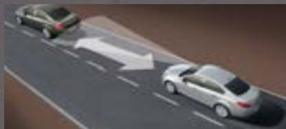
A indicação da distância de segurança (FDI) apresenta de forma contínua a distância em relação ao veículo da frente no painel de instrumentos, ajudando a evitar multas por incumprimento da distância mínima. O sistema de aviso de colisão frontal (FCA) é activado durante a condução a velocidades superiores a 30 km/h e emite um aviso visual e sonoro na iminência de uma colisão.
