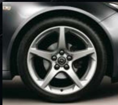
5 Jantes de liga leve, 8,5 J x 19, design de 5 raios, pneus 245/40 R 19 (Q93). Liga leve fundida com acabamento Premium de revestimento múltiplo.
