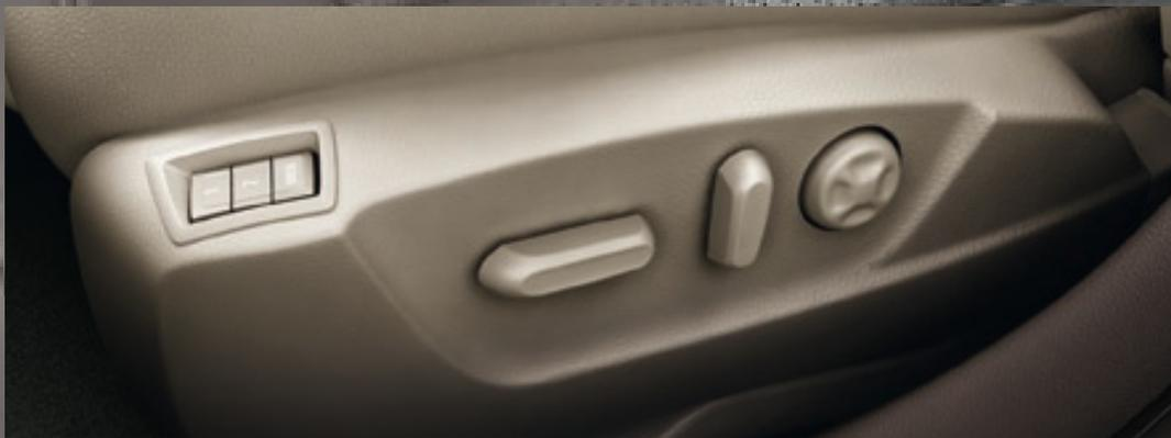
**Função de memória dos bancos de ajuste eléctrico.** É possível definir rapidamente as preferências individuais do condutor através dos comandos dos bancos de ajuste eléctrico e dos espelhos retrovisores, e basta um simples toque no botão para as guardar. Podem ser programadas duas posições diferentes.
