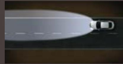
**Luz de máximos assistida (acima dos 40 km/h).** Altera automaticamente as luzes de máximos para as luzes de médios sempre que detecta a proximidade de veículos, atrás ou no sentido contrário.
