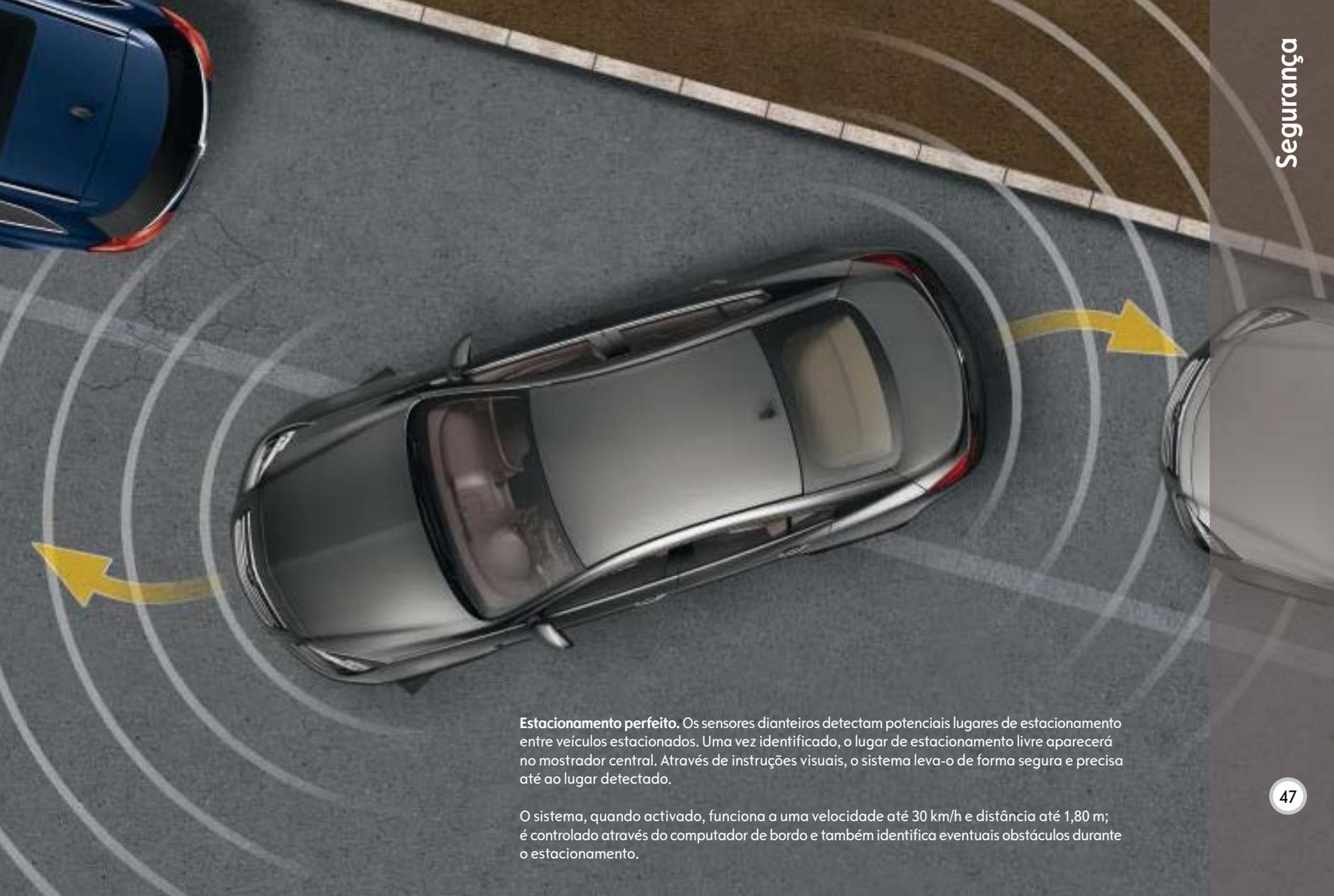
**Estacionamento perfeito.** Os sensores dianteiros detectam potenciais lugares de estacionamento entre veículos estacionados. Uma vez identificado, o lugar de estacionamento livre aparecerá no mostrador central. Através de instruções visuais, o sistema leva-o de forma segura e precisa até ao lugar detectado.
