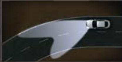
**Luzes dinâmicas de curva (a qualquer velocidade).** Activados pelo movimento da direcção e pela velocidade, os faróis rodam até 15 graus quando o automóvel descreve uma curva.
