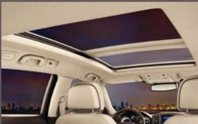
**Tejadilho panorâmico.** O tejadilho de duas secções praticamente a todo o comprimento maximiza a luz natural e o ambiente. É composto por uma secção traseira em vidro fixa e uma secção dianteira que pode ser aberta, pré-programável, com função de spoiler. Uma cortina eléctrica cobre todo o tejadilho para protecção da luz solar intensa.
